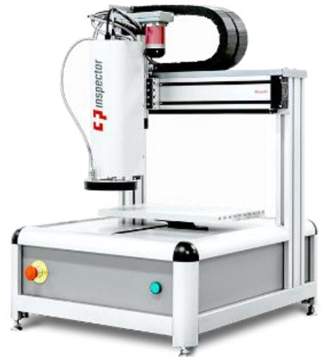
**BECKHOFF** Ce travail de diplôme a pour but de piloter les 3 axes sans utiliser la NC Beckhoff et en passant directement par les cartes moteurs. Divers tests de fonctionnement sont à réaliser afin de vérifier les bons fonctionnements du programme et son comportement lors des phases critiques. Le cycle de vision est également intégré au programme.
